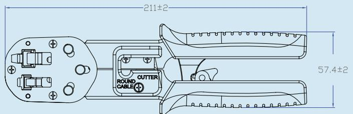
Crimpeadora para conector FastPlug RJ-45 y conectores RJ11 y RJ-45 Estándar
